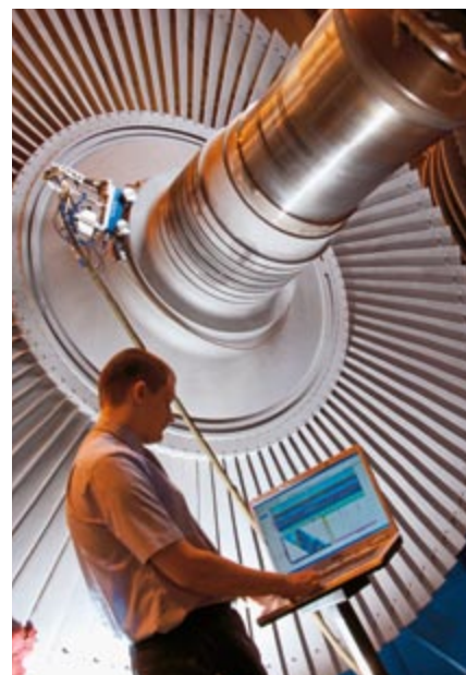
Inspection d'un rotor avec la technologie de pointe d'Alstom Inspection Robotics.
