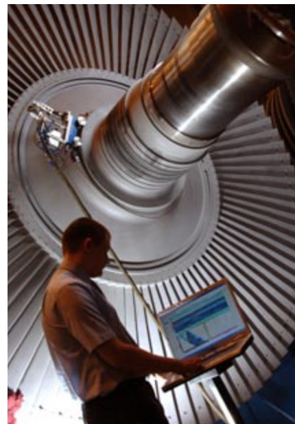
Rotorinspektion mit modernster Technologie von Alstom Inspections Robotics.
